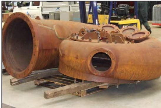
Bomba de acero fundido fabricado en 1949, con diámetro de 2,5 m y caudal 30 m 3 /min.
